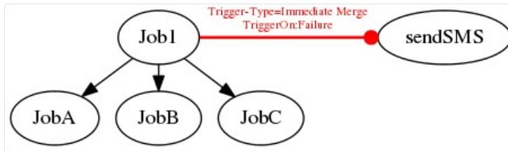
Abbildung 15.36: Beispiel für Immediate Merge Trigger
