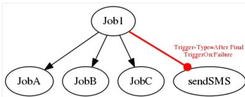
Abbildung 15.39: Beispiel für After Final Trigger
