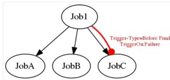
Abbildung 15.38: Beispiel für Before Final Trigger
