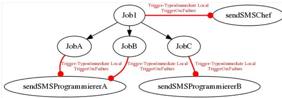
Abbildung 15.37: Beispiel für Immediate Local Trigger
