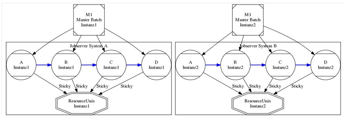
Abbildung 15.28: Beispiel für Lastverteilung mit Sticky Handling
